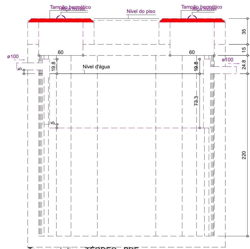
Tanque séptico - TÉRREO - PRF Corte 1 - ESC. 1:25
